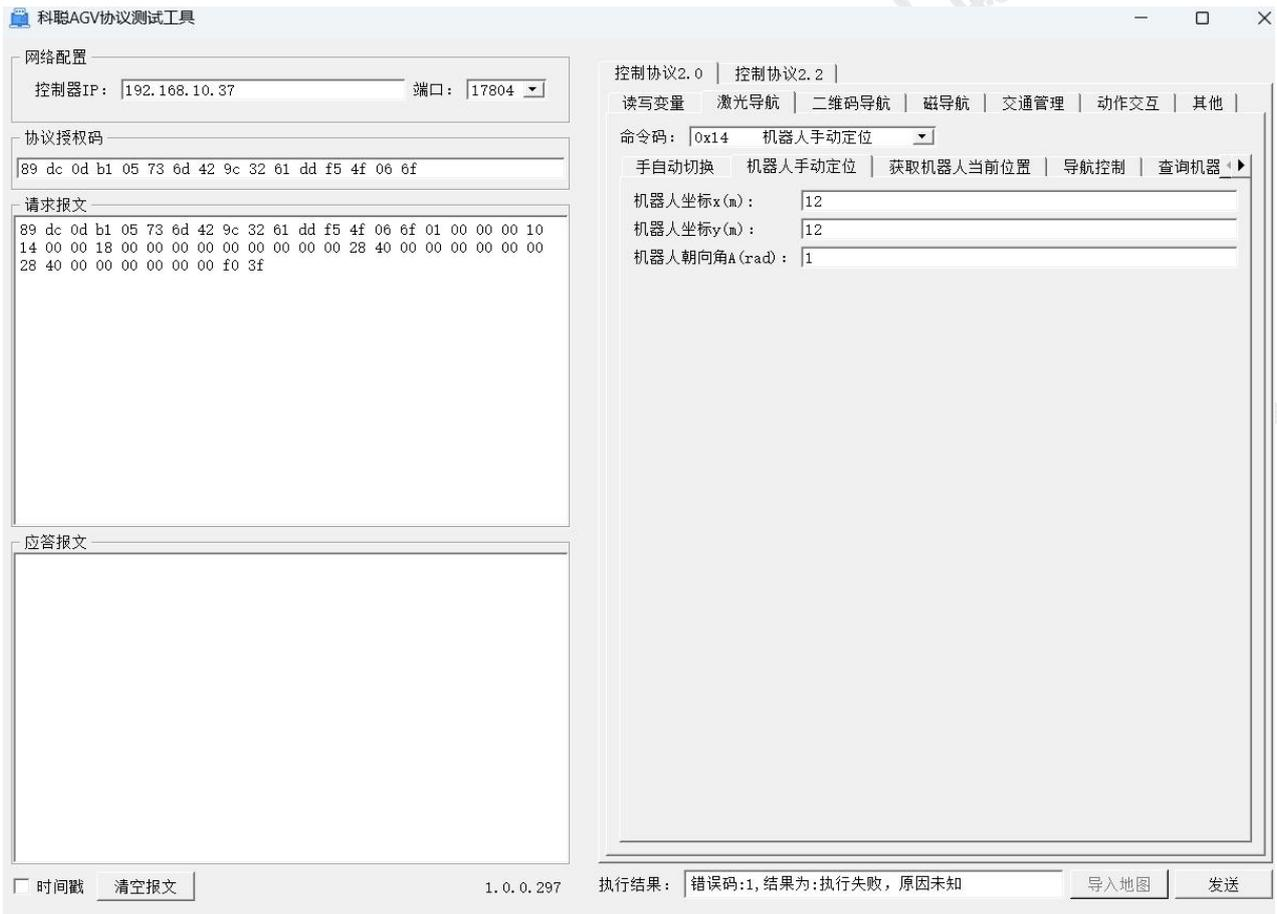
图 5.2 机器人手动定位
